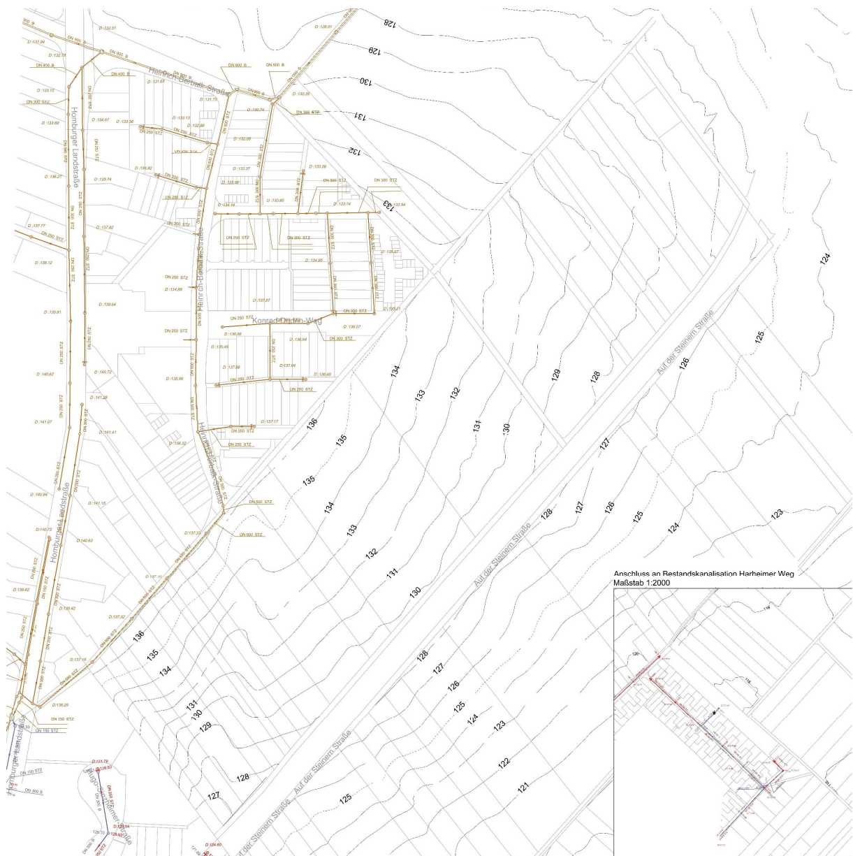
Abbildung 3: Bestehendes Kanalnetz im Umfeld des Plangebietes [U8]
