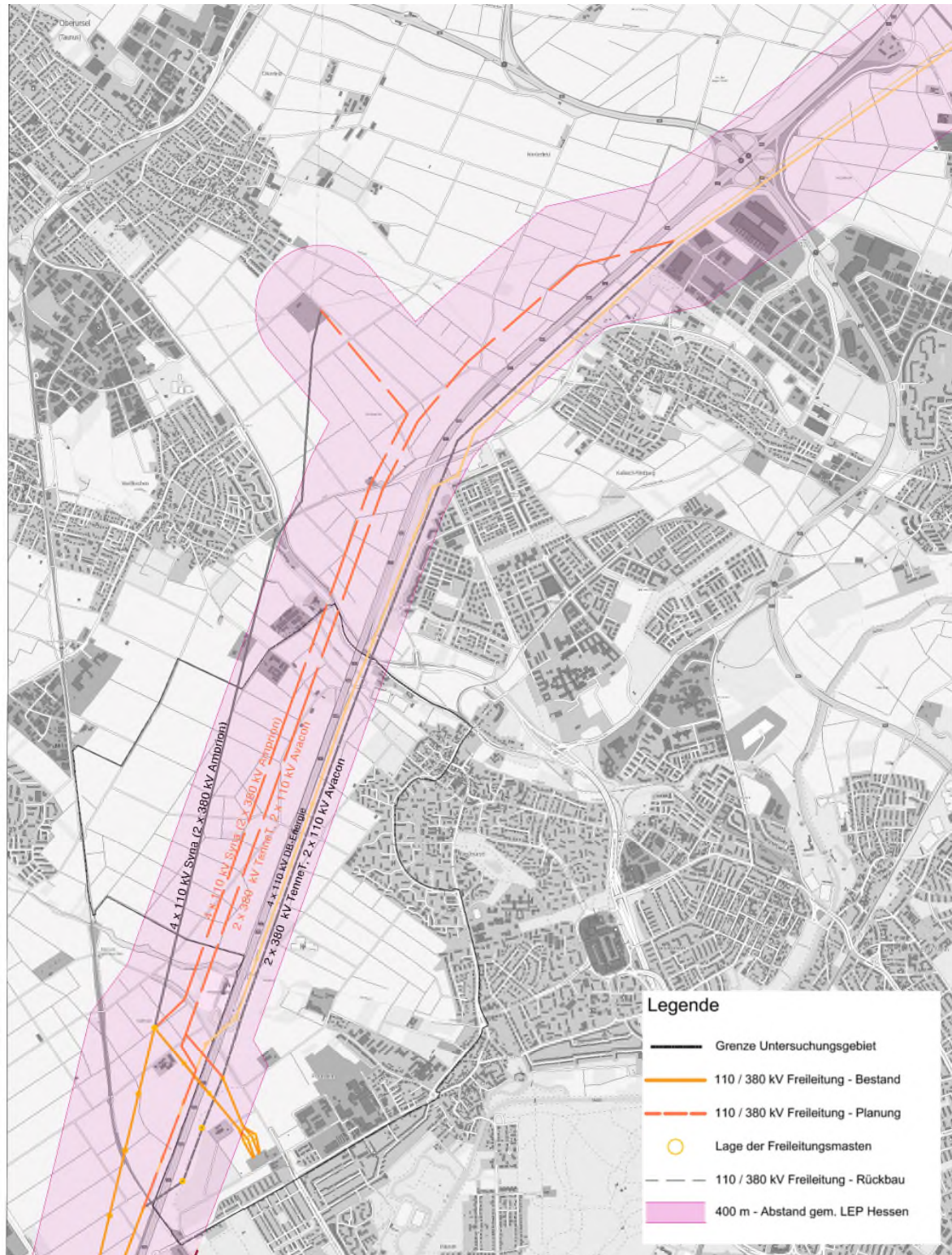
Abbildung 53: Trassenverlauf bei Verlegung der Höchstspannungsleitungen (Geobasisdaten: © Stadtvermessungsamt Frankfurt am Main, Stand 03.2017, © Hessische Verwaltung für Bodenmanagement und Geoinformation; Karte bearbeitet durch Stadtplanungsamt der Stadt Frankfurt am Main, 2021)
