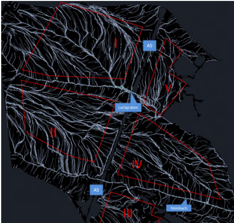
Abbildung 13: Simulation Fließwege Bestandsituation
