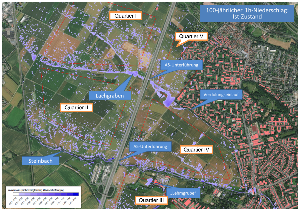
Abbildung 2: Überflutungsflächen mit Wassertiefen ( T_n = 100a , T_D = 1h ), Ist-Zustand
