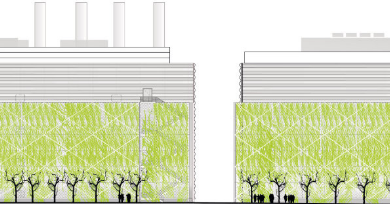
Aufriß Rechenzentrum Friesstraße 7: Begrünte Rankgitter beschatten und kühlen die Außenwand, © Arup Deutschland GmbH
