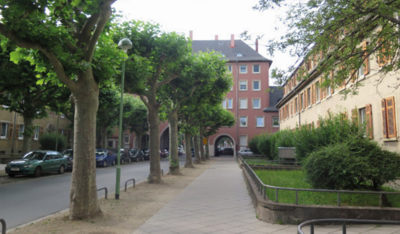
Helle Gehwegflächen, neugeordnetes Parken, Versickerungsflächen in der Flucht der Platanenallee: Die Schafflestraße im Frühsommer
