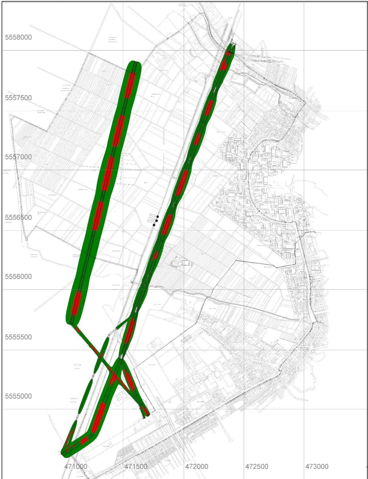
Abb. 22: Bereiche der Überschreitung der Störfestigkeitsrichtwerte für Industrie (rot) und Wohn- bzw. Gewerbeumfeld (grün) - Berechnungshöhe 15 m.
