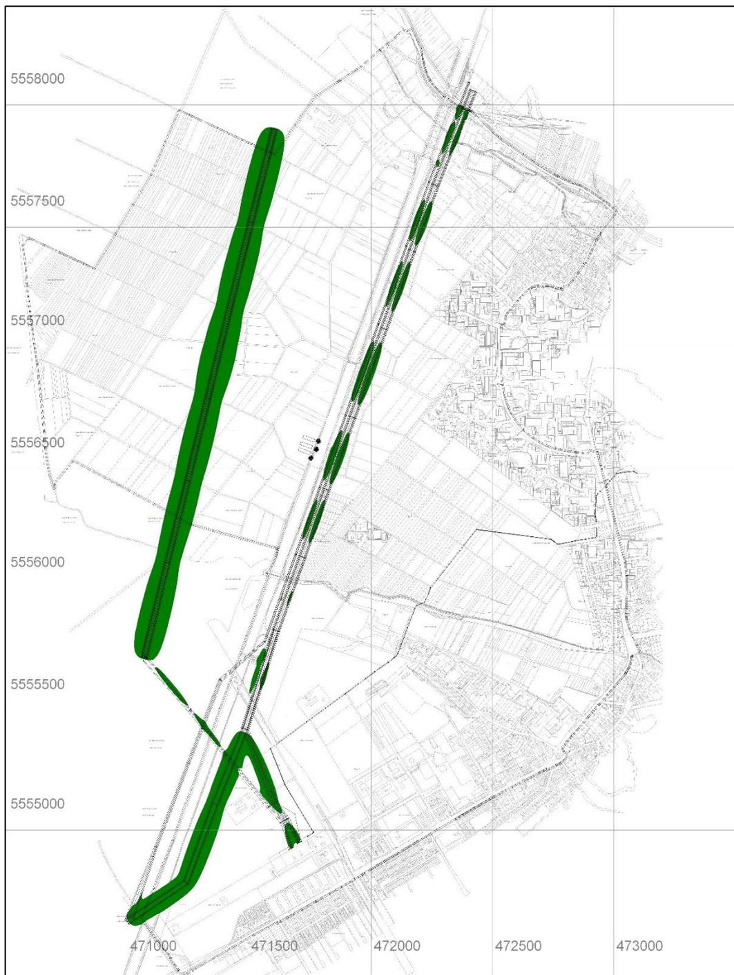
Abb. 21: Bereiche der Überschreitung der Störfestigkeitsrichtwerte für Industrie (rot) und Wohn- bzw. Gewerbeumfeld (grün) - Berechnungshöhe 1 m.
