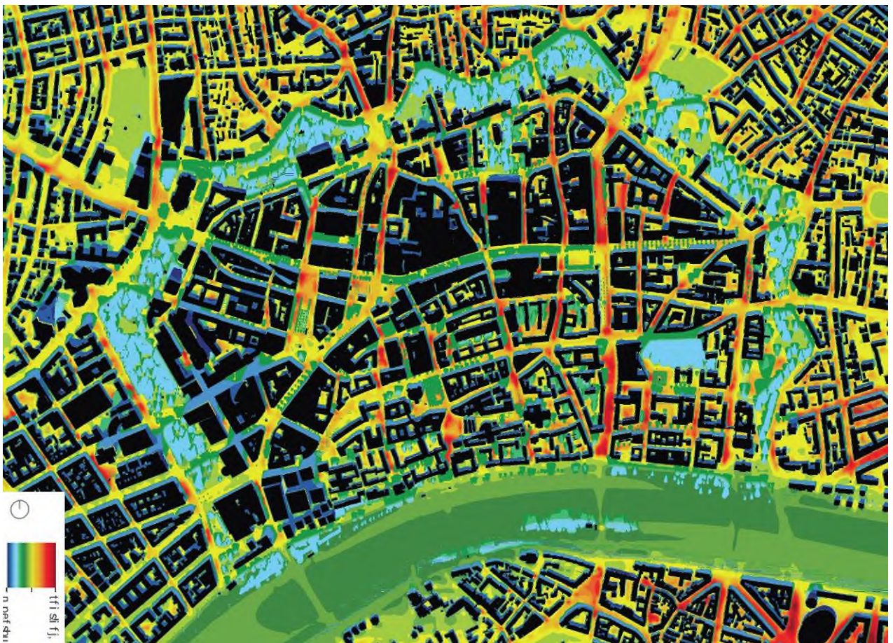
Darstellung der heutigen bioklimatischen Verhältnisse anhand der „ abgeleiteten mittleren Strahlungstemperatur “ (Universität Kassel, Fachgebiet Umweltmeteorologie, 2013)
