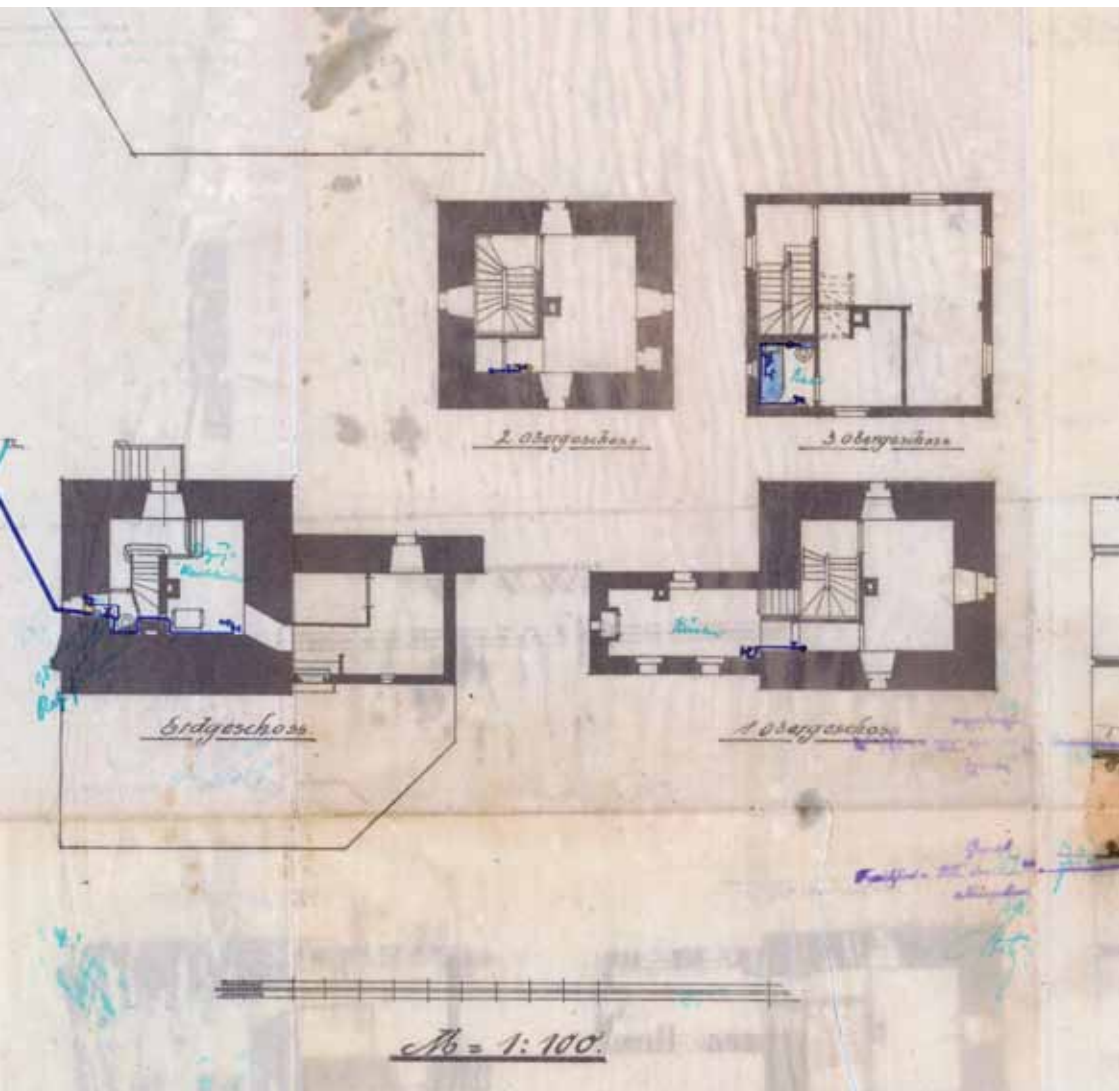
Abb. rechte und linke Seite: Bewässerungsplan des Kuhhirtenturms; zu sehen sind hier die Grundrisse mit der Aufteilung der Flächen samt Schnitt durchs Gebäude, Plan aus einer städtischen Akte, 1924 © Institut für Stadtgeschichte
