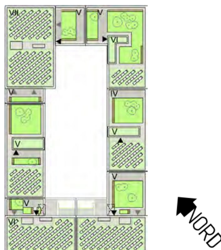
Abb. 56: Exemplarische Darstellung des Dachflächenkonzepts für einen geplanten Wohnblock. (Quelle: Bürogemeinschaft Kölling und Crossboundaries Architekten)
